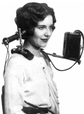
Dispositivo inventado para que as telefonistas tivessem as mãos livres, e aparelho de telefonista no início do século XX
